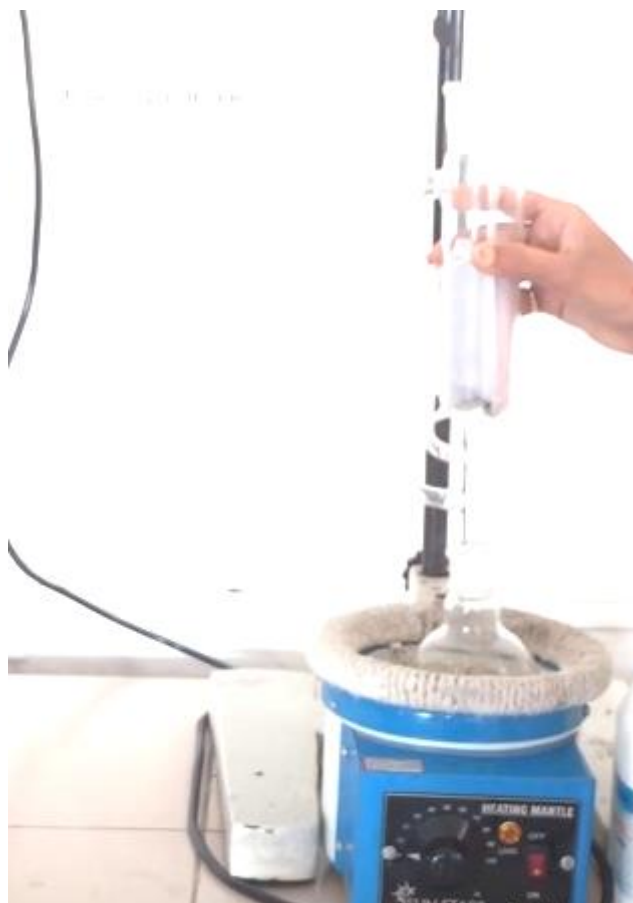
Figure-2 : Soxhlet apparatus
